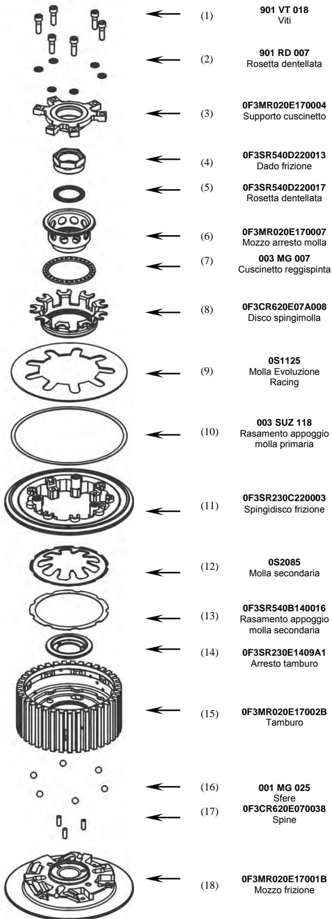
Premontare il gruppo mozzo: collocare le 6 sfere (16) al fondo delle scanalature del mozzo (18) applicando una piccola quantità di grasso, quindi con una vite M6x1 fissare il tamburo (15) sul mozzo (18) in posizione di riposo.
